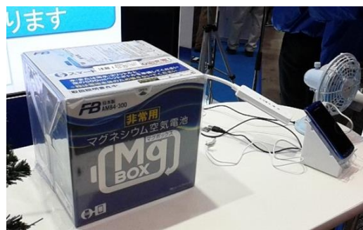
【写真 15 : マグネシウム空気電池】
