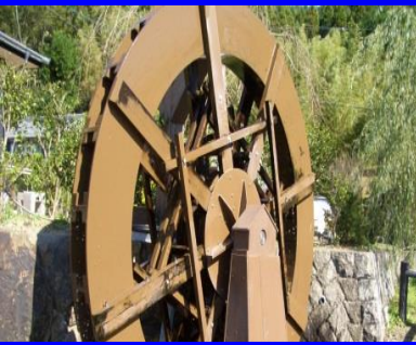
浄化センター排水監視 ピコ水力発電
